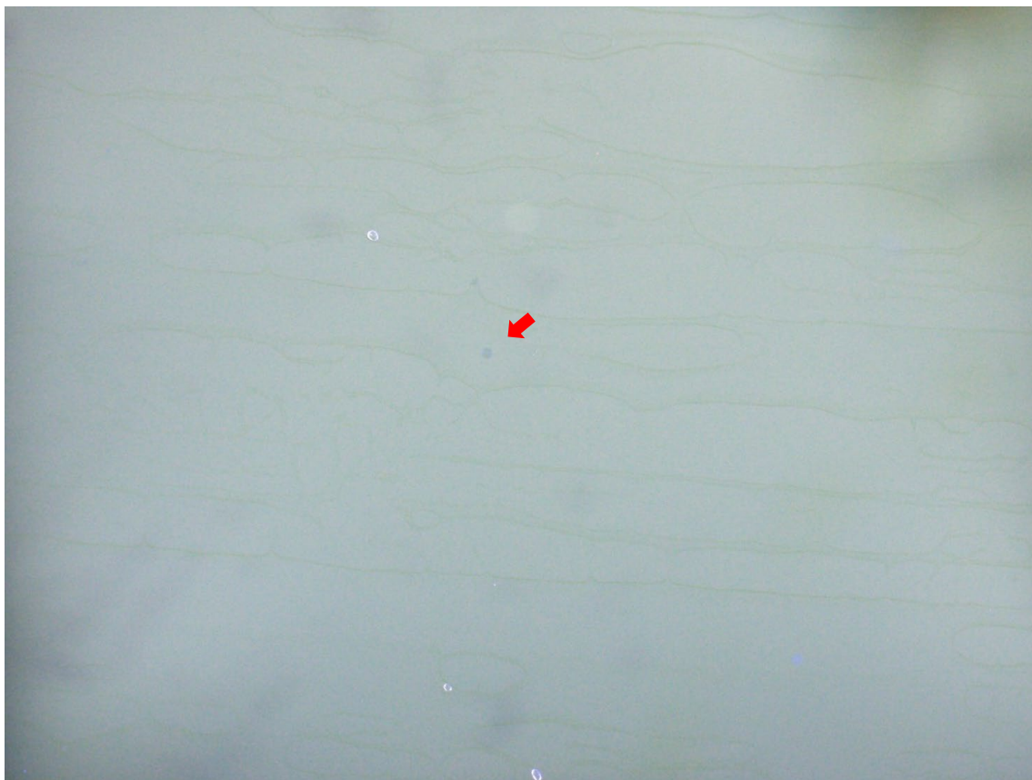
少量飛散(12 個/cm 2 )の時の花粉計測スライドの写真 (顕微鏡の倍率 : 40 倍)
